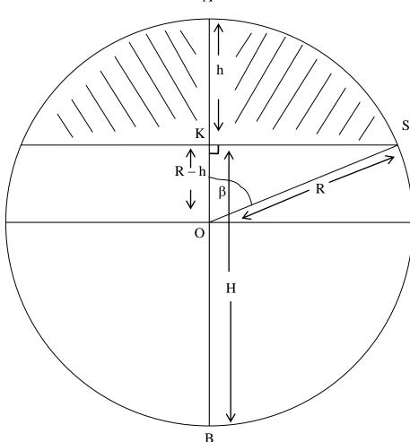
$$\text{O'(liquide en litres)} = 1\,000\,\pi\,R^2\,L - 1\,000\,R^2\,L\,[\text{Arc}\cos\frac{R-h}{R} - \frac{\sin\,[2\,\text{Arc}\cos\frac{R-h}{R}]}{2}]$$
