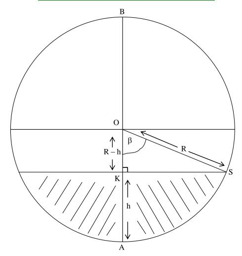
Soit R le rayon de la cuve cylindrique, L sa longueur et h la hauteur du liquide (hachuré) dans la cuve.
